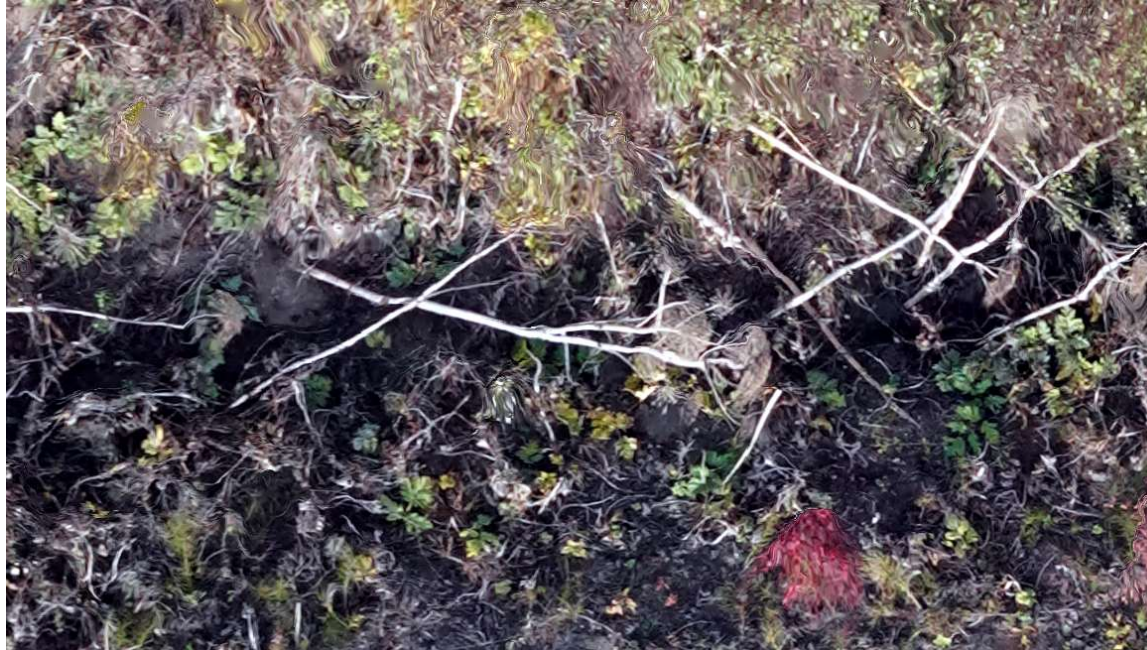
Ilustracja 4 Rozmycia występujące na ortofotomapie w miejscach dużych nachyleń i skomplikowanej strukturze roślinności.
