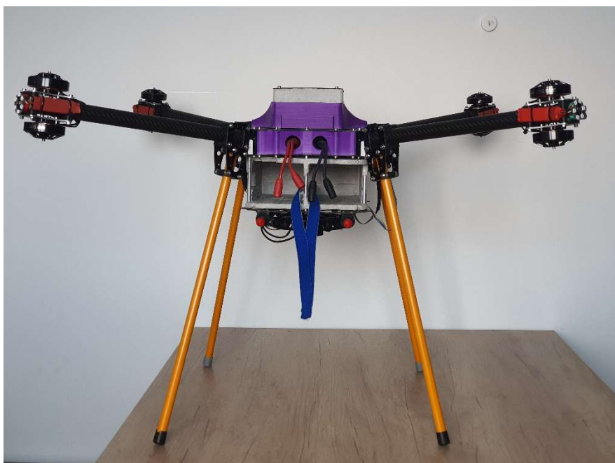
widok z tyłu: przerobiona obudowa akumulatorów umożliwiająca loty zimą.
