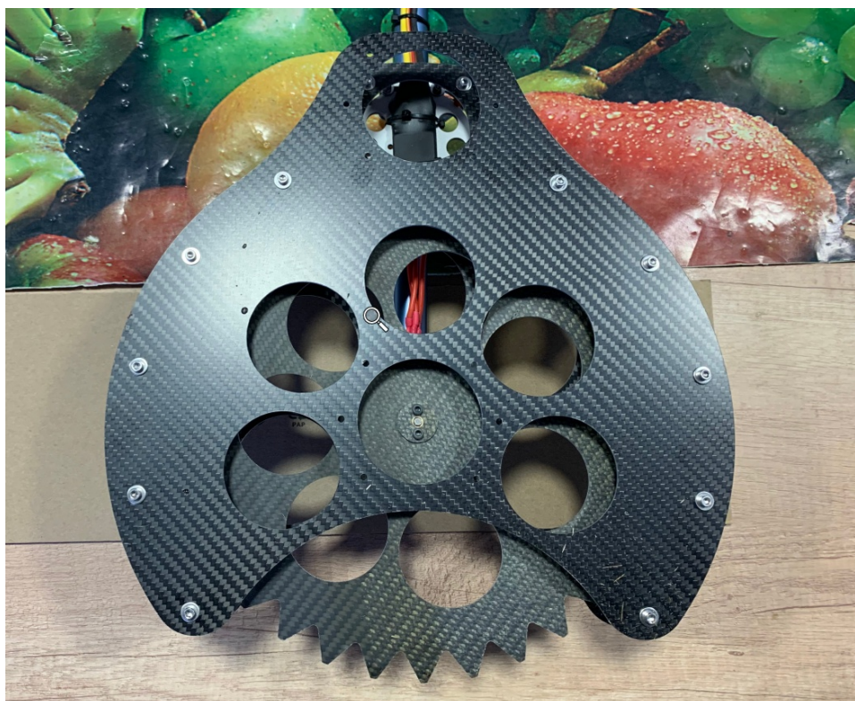
Ilustracja 22: Lekka głowica tnąca po przeprojektowaniu.
