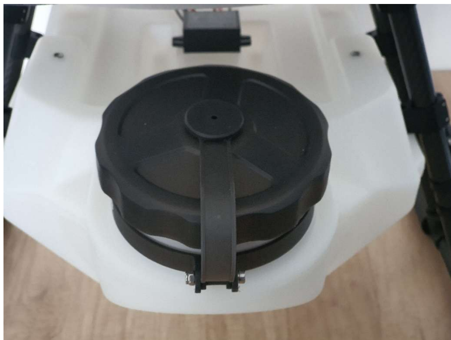
Przód zbiornika z wlewem z tyłu widać regulator obrotów pompy
