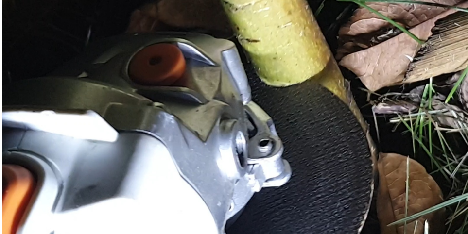
Ilustracja 16 Zatrzymane ostrze pilarki po zakleszczeniu.
