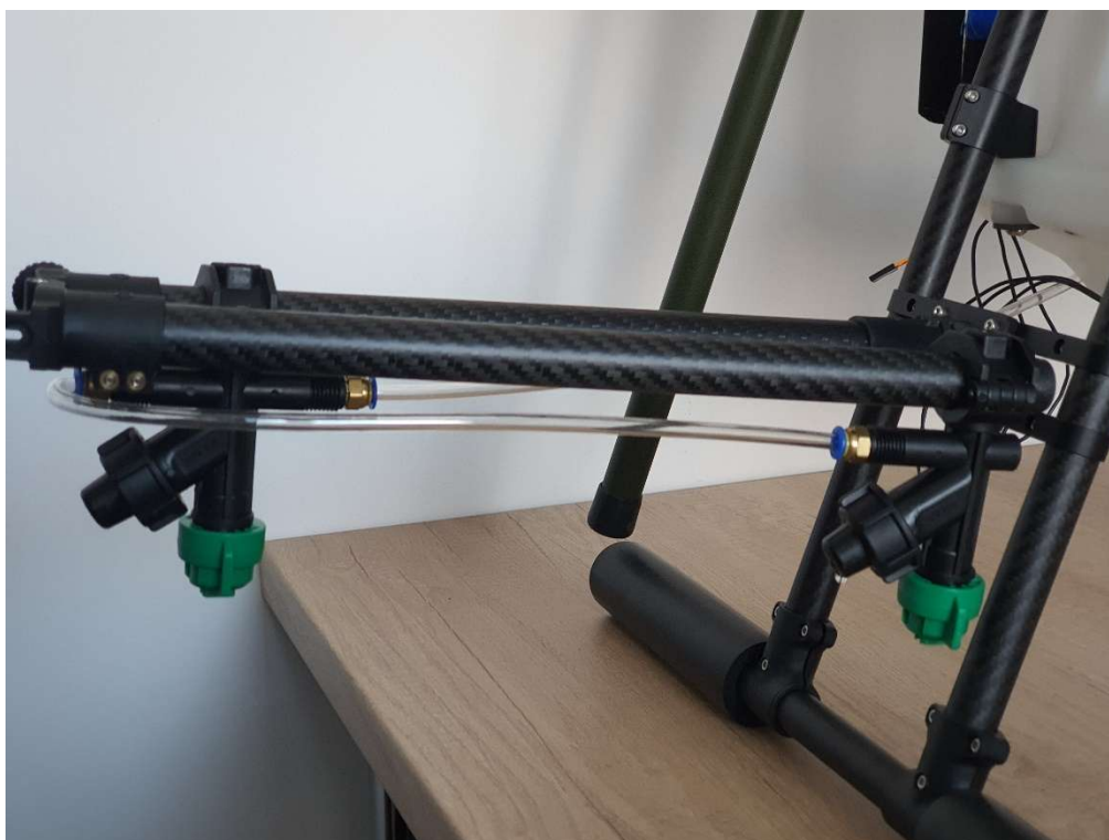
Widok ramienia złożonego na poziomym zawiasie
