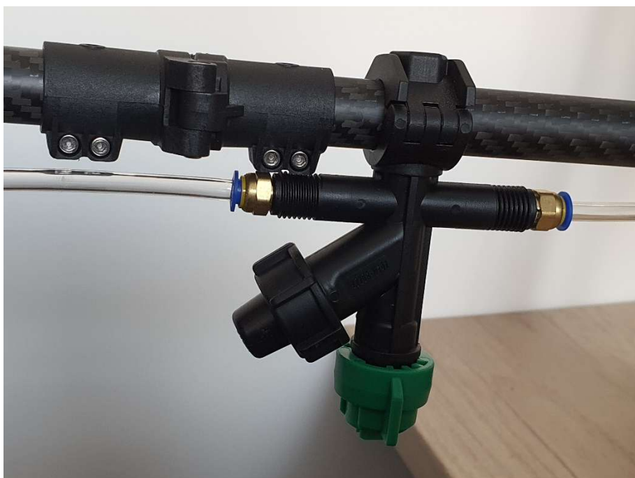
Widok na poziomy zawias ramienia i wewnętrzny tryskacz z zieloną głowicą
