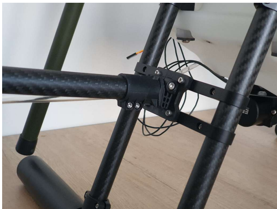
Wykonane mocowanie ramiona do oprysków i jego mocowanie do stałego podwozia
