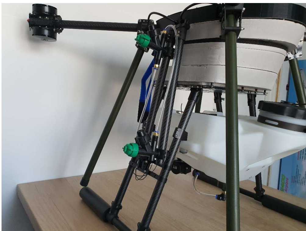
Widok całego ramienia złożonego na pionowym zawiasie do transportu
