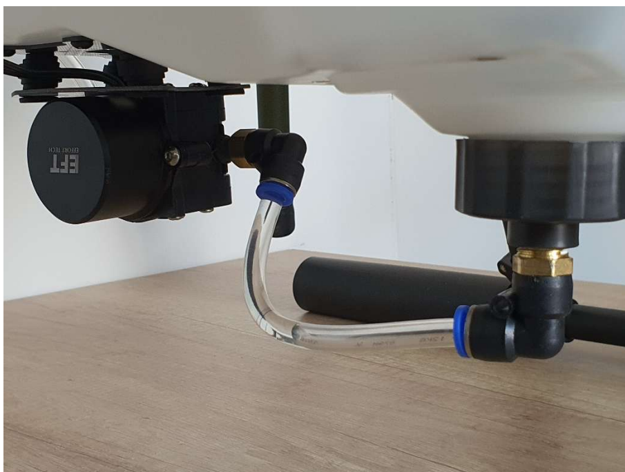
Widok pod zbiornik: widać pompę wysokowydajną i główny zawór ciecży
