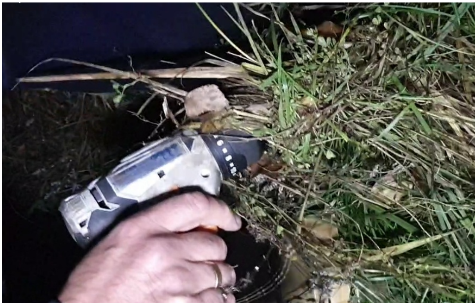
Ilustracja 6 Dystorsja osi frezowania i owinięcie się liśćmi traw.
